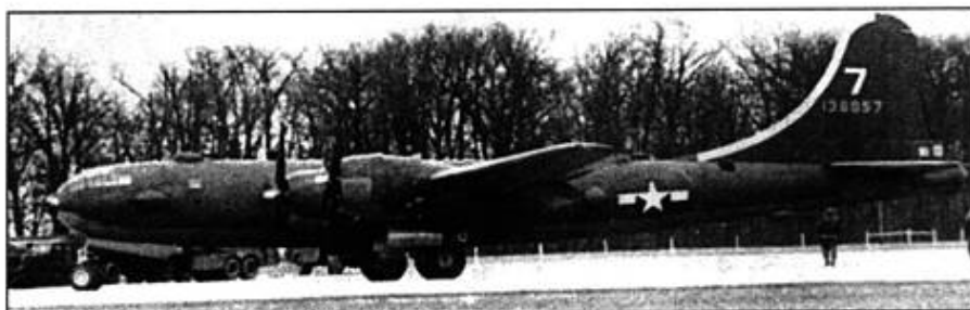
Седьмой YB-29 в порядке эксперимента оснащен сферической установкой «ЭРКО» в носу фюзеляжа, и бортовыми турелями, разработанными для самолетов «Конвейер РВ4У-2 Прайватир» и «В-32А Доминатор».
