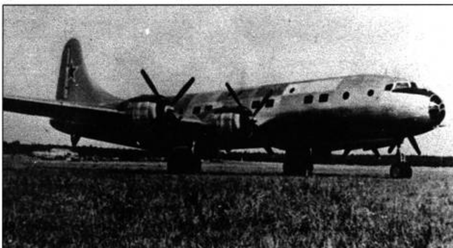
Ту-70 был пассажирским самолетом, созданным на базе Ту-4. Самолет имел крылья и хвостовое оперение от В-29, но совершенно новый фюзеляж.
