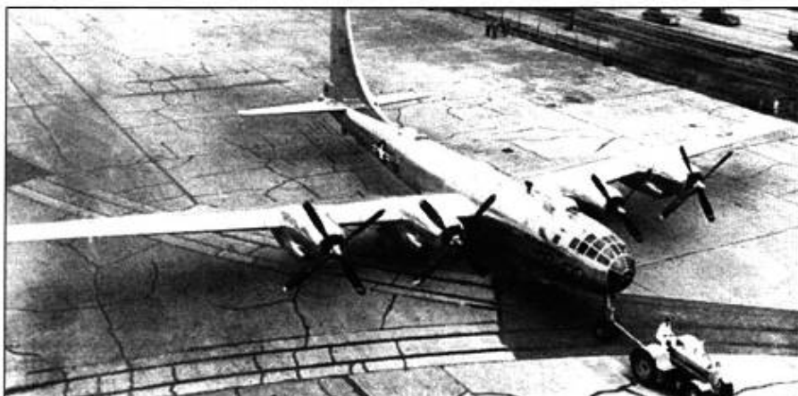
Первый В-50А, июнь 1947 года, аэродром фирмы Боинг. Самолеты В-50А оснащались двигателями «Пратт-энд-Уитни R-4360-35» мощностью 3500 л.с. Киль самолета был на 5 футов выше, чем у В-29.
