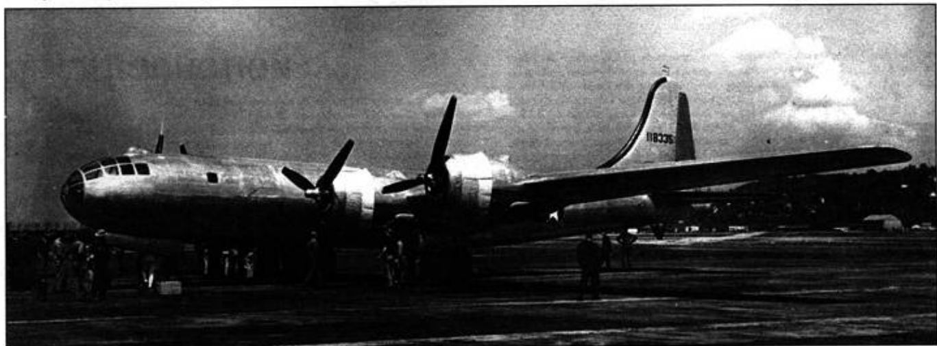
Третий XB-29 на площадке аэродрома Боинг-Филд, июнь 1943 года. Виден каплевидный навигационный купол над кабиной. Трехлопастные винты были характерны для всех XB-29.
