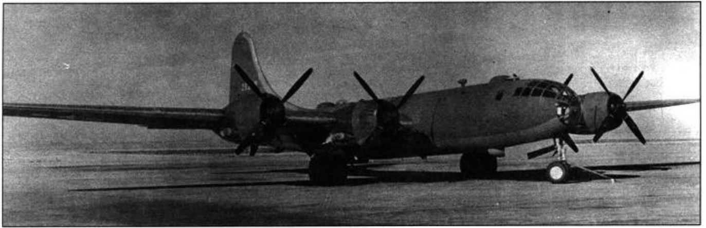
В-29-1 отличался от ХВ-29 наличием дистанционно управляемых турелей и четырехлопастными винтами «Гамильтон Стандарт». Первый В-29-1 покинул сборочный цех завода в Уичта осенью 1943 года.
