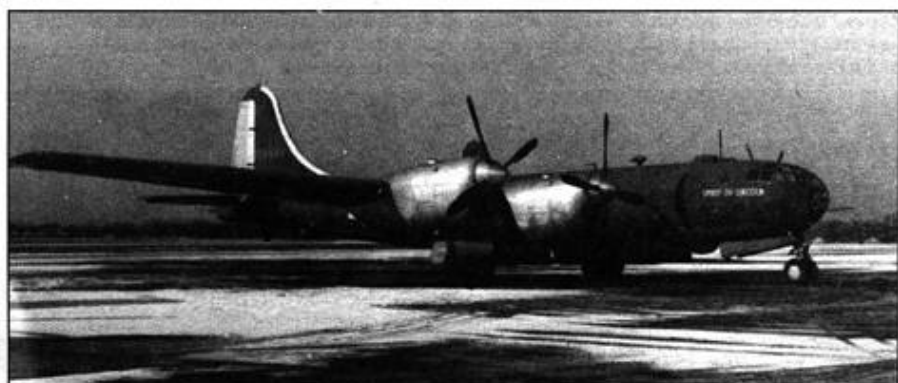
Первый YB-29 с установленными на нем рядными 24-цилиндровыми двигателями жидкостного охлаждения «Аллисон V-3420-11». Фактически, двигатель V-3420 представлял собой спарку двигателей V-1710.
