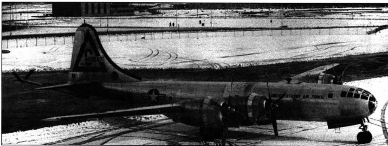
KB-29P из 509-й эскадрильи на заснеженном аэродроме «Лейкенхит», 1954 год. KB-29P брал более 12000 галлонов топлива JP-4 для реактивных самолетов.
