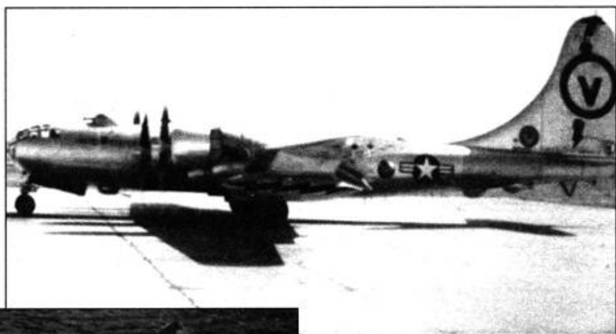
B-50F из 55-го крыла стратегической разведки, база Форбс, Канзас, 1953 год. B-50F имели дополнительные антенны «ELINT», включая большой радар под хвостовой частью фюзеляжа.
