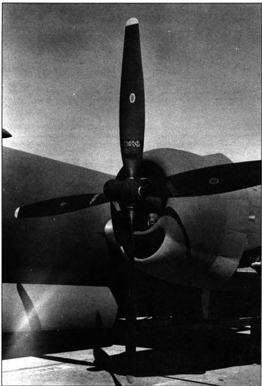
Серийные В-29 оснащались четырехлопастными винтами «Гамильтон Стандарт» диаметром 16 футов 7 дюймов. На прототипах стояли трехлопастные винты диаметром 17 футов.
