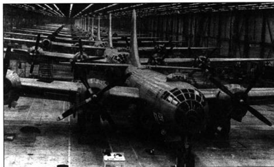
Массовая сборка бомбардировщиков В-29 в Рентоне. Всего с сентября 1942 по май 1946 было построено 3960 самолетов В-29.
