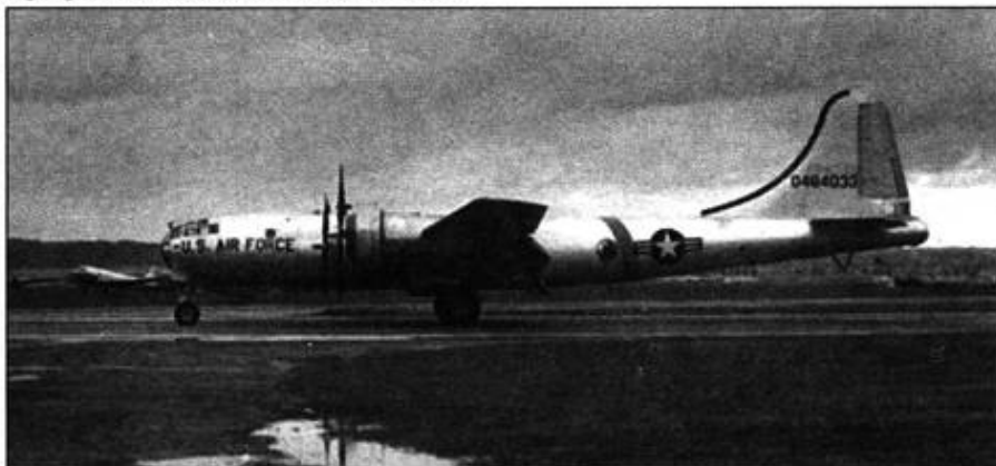
Один из B-29, переделанных в летающий командный пункт и обозначенный как VB-29. Этот VB-29B украшен изображением Млечного пути, лентой проходящим через створки носового люка и заднюю часть фюзеляжа. Ноль в начале серийного номера показывает, что самолет находится на службе уже более 10 лет.
