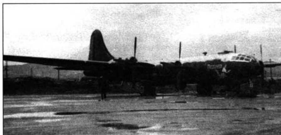
В-29 «Reserved» из 98-й группы, Йокота, Япония, коней 1951 года. Нижняя сторона самолета выкрашена блестящей черной краской - ночной камуфляж.
