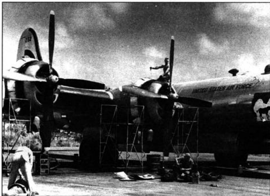
Идет регулировка двигателя R-3350 на В-29 «Mule Train» из 22-й группы, Кадена. 22-я группа перебазировалась в Кадену в июле 1950 года, вместе с тремя другими группами, направленными для службы в Корее.
