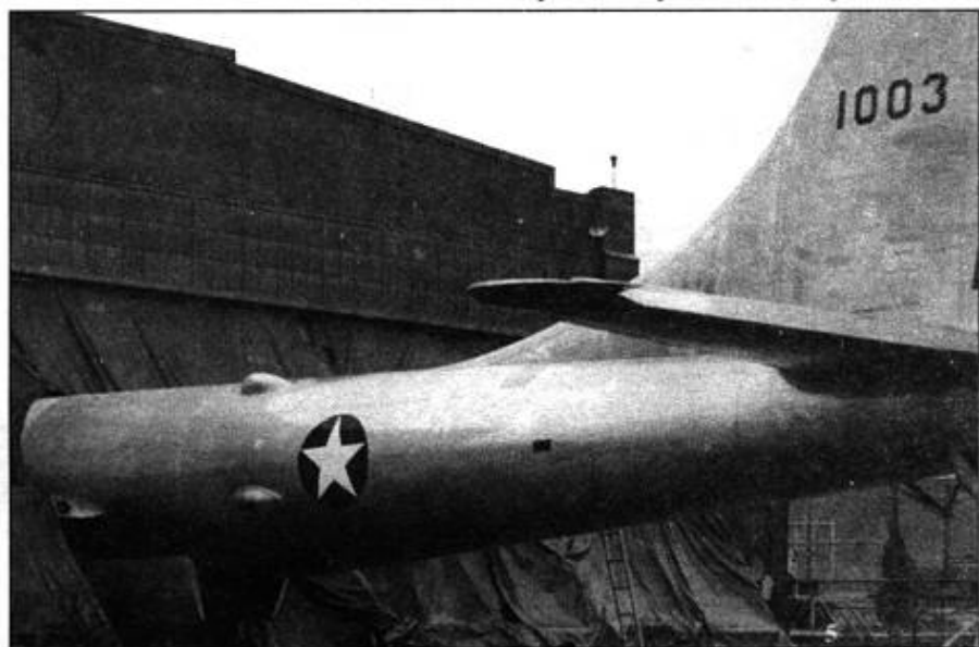
Хвостовая часть фюзеляжа второго XB-29. Каплевидные блистеры, турели отсутствуют. На месте «бампера» под хвостом убирающийся в полете костьль. Этот самолет разобьется, весь экипаж, включая летчика-испытателя Эдди Аллена, погибнет.
