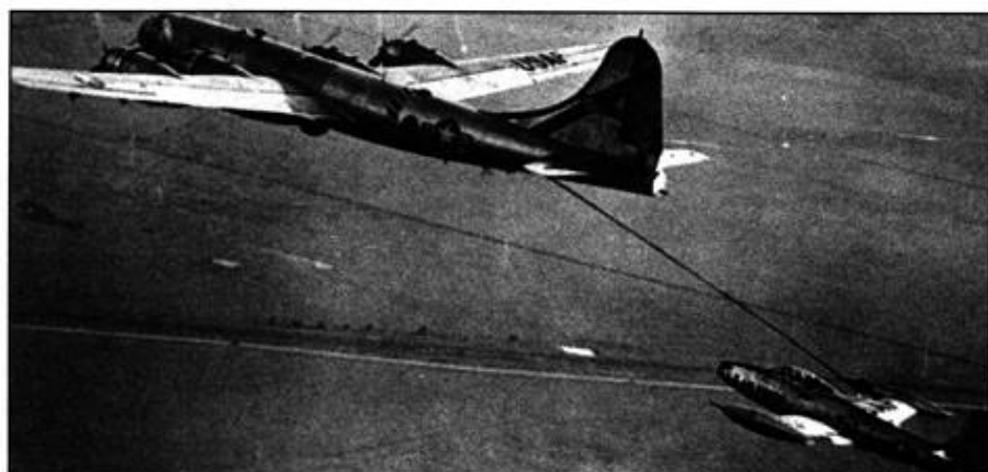
KB-29M из 421-й заправочной эскадрильи заправляет истребитель F-84E из 49-й истребительно-бомбардировочной группы. У F-94E имеется входной патрубок на топливном баке на конце крыла.
