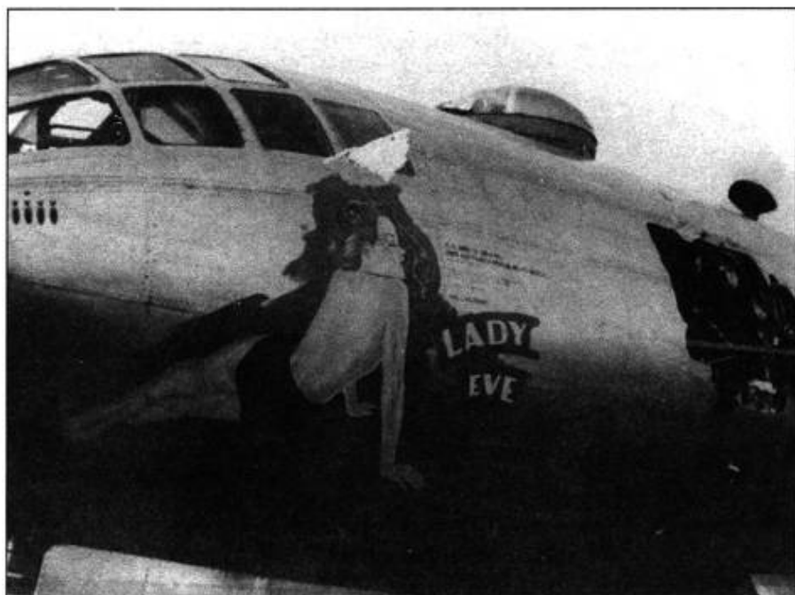
В-29-5-ВА (42-65211, «Lady Eve») Дж. Рассела Чивера из 498-й группы на аэродроме Айли-Филд, Сайпан. В борту фюзеляжа зияет огромная дыра от зенитного снаряда.
