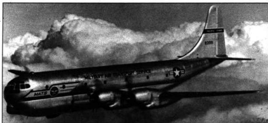
Военно-транспортный С-97А над Перл-Харбором, начало 50-х годов. С-97А/КС-97А использовали крылья, хвост и двигатели от В-50. Всего фирма «Боинг» построила 888 самолетов С-97/КС-97.
