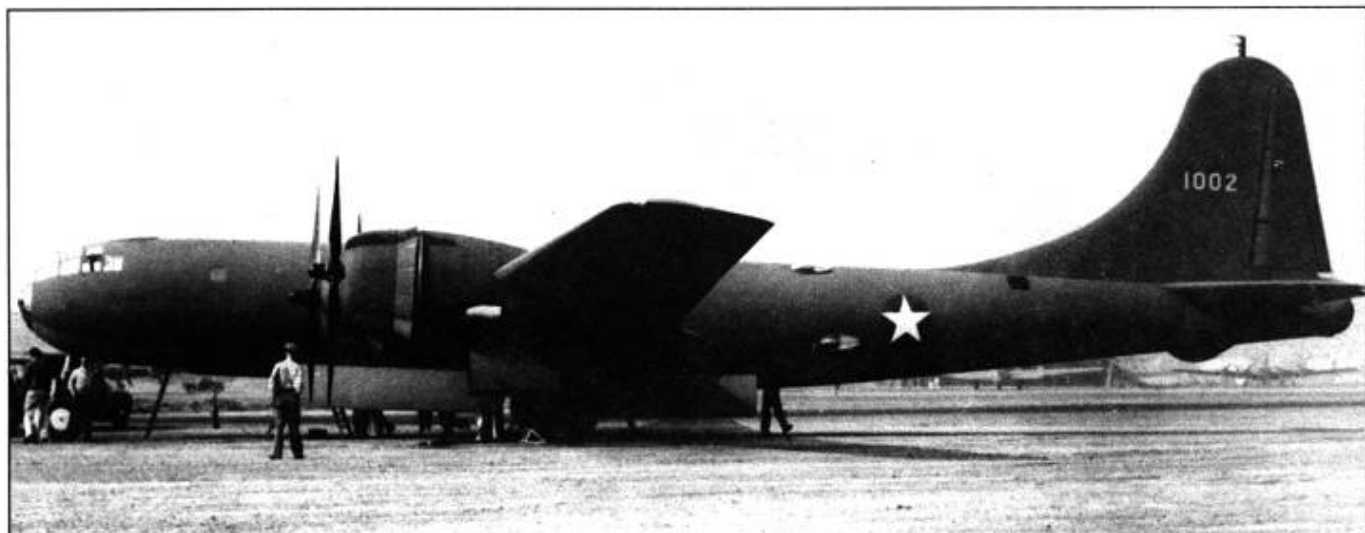
XB-29, сентябрь 1942 года. Обтекаемый бампер под хвостовым оперением, небольшие блистеры на месте позднейших постов управления турелями, большой руль направления - черты, характерные для XB-29.
