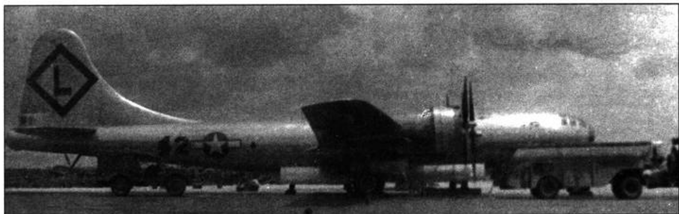
В-29В на полосе аэродрома Айли-Филд, Сайпан. Почти все В-29В действовали в составе 315-го бомбардировочного крыла. Многие из них оснащались радаром AN/APQ-7 «Игл», обладающим высокой разрешающей способностью.
