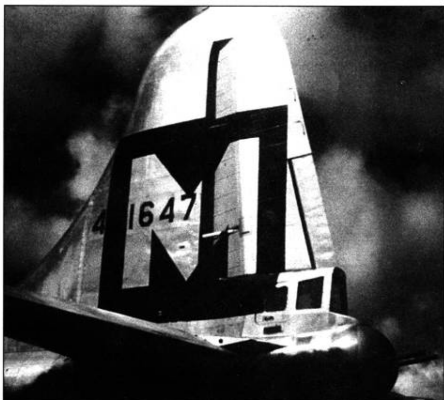
B-29 из 19-й группы. В хвостовой установке только пара 12,7-мм пулеметов.
