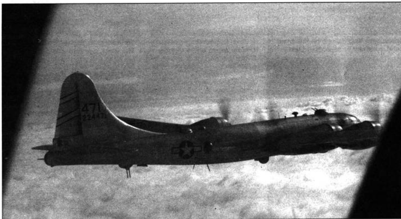
Вид через окно с кресла пилота. Снимок сделан на борту В-29 из 468-й бомбардировочной группы, Аньшань, Манчжурия, 8 сентября 1944 года. Под фюзеляжем виден обтекатель антенны радара АРQ-13.
