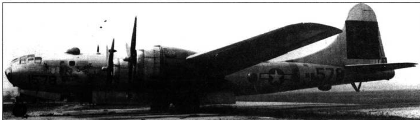
F-13A «Sweet n' Lola» из 509-й группы, июль 1946 года, испытания атомной бомбы на атолле Бикини. Под фюзеляжем можно разглядеть вырез для вертикальной фотокамеры.
