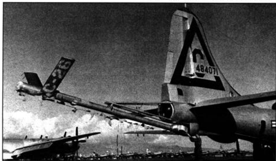
KB-29P оснащались оригинальной заправочной системой, разработанной фирмой «Боинг». Система состояла из телескопического металлического безопровода с небольшим стабилизатором на конце. Работой системы управлял специально обученный оператор.
