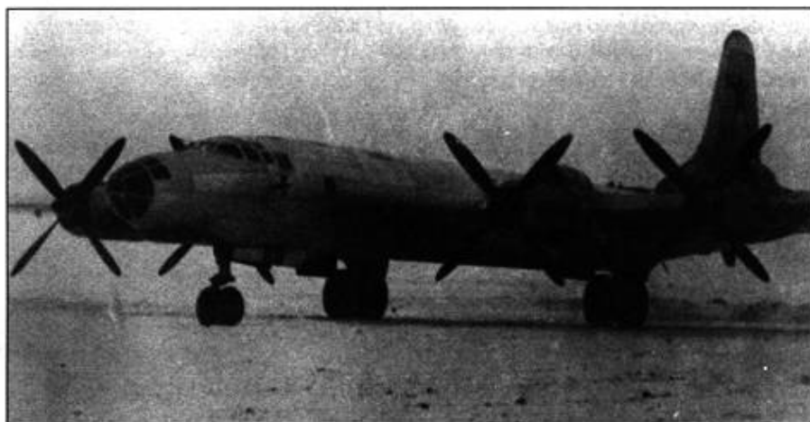
Ту-85 представлял собой последнюю фазу развития конструкции Ту-4. Самолет отличался удлиненным фюзеляжем и крылом большого размаха. Двигательная установка состояла из четырех 4300-сильных двигателей ВД-4К. Самолет развивал скорость до 750 км/ч и пролетал до 12200 км. На короткие дистанции самолет мог брать до 20000 кг бомб.
