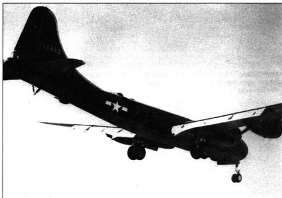
Шестой YB-29 садится на Боинг-Филд. Большие закрылки Фаулера выпущены со сдвигом назад. Это значительно увеличивало площадь крыла.
