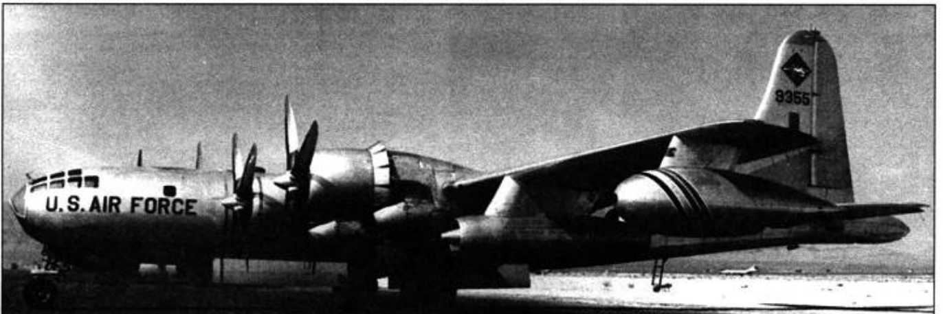
KB-50J «Miss Bea» из 421-й заправочной эскадрильи, 1964 год. Многие KB-50J имели дополнительные двигатели «Дженерал Электрик J47», которые позволяли увеличить скорость и потолок самолета, что облегчало взаимодействие с реактивными истребителями.
