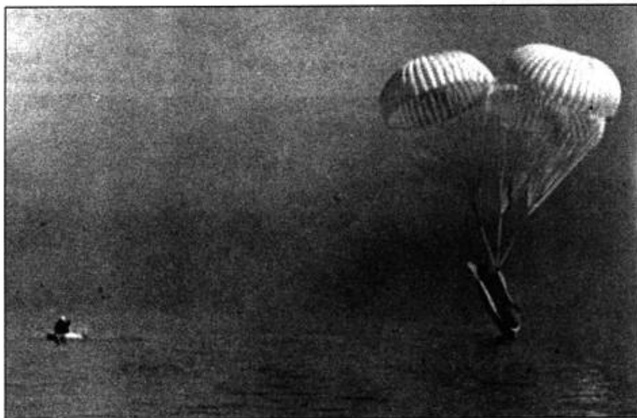
Спасательная лодка EDO A-3 сейчас коснется воды. Лодка имела в длину 29 футов 9 дюймов. На ней хранились запасы пищи, воды, аварийный радиопередатчик и карты.
