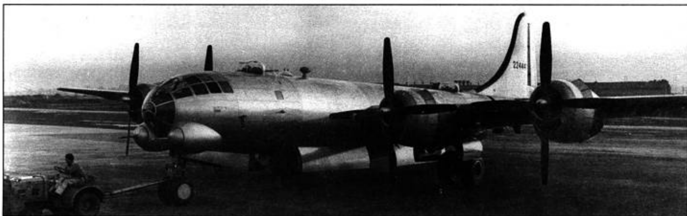
На B-29 пытались поставить разного типа турели. Этот B-29 оснащен верхними турелями от B-17 и шаровидными турелями под фюзеляжем. Все турели обслуживаются сидящими в них стрелками. По бортам установлены одиночные 12,7-мм пулеметы.
