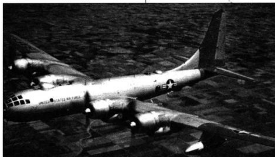
B-50F из 55-го крыла стратегической разведки, база Форбс, Канзас, 1953 год. B-50F имели дополнительные антенны «ELINT», включая большой радар под хвостовой частью фюзеляжа.
