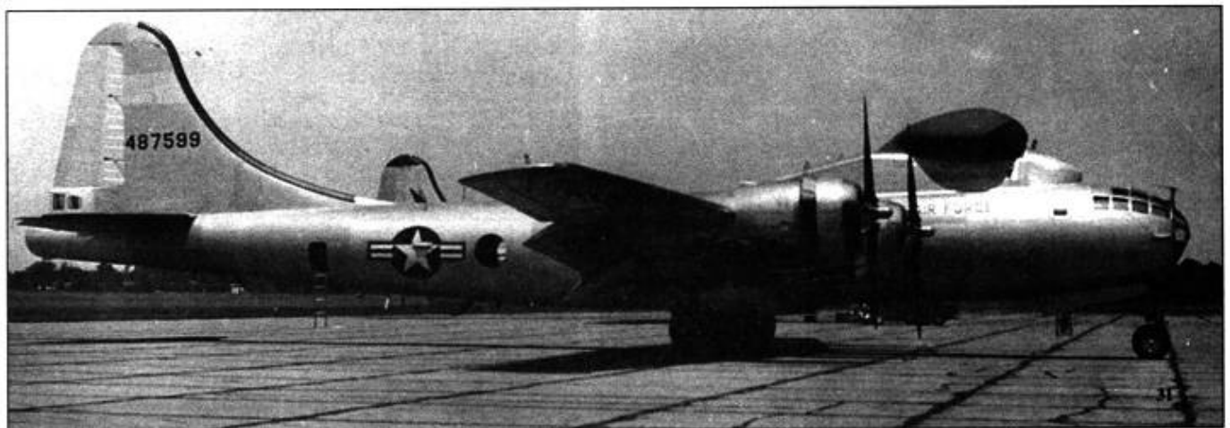
Этот В-29, переданный в морскую авиацию, был оснащен большим радаром, установленным на фюзеляже. При этом обозначение самолета изменили на P2B-1S.
